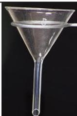
**Funil simples:** Pode ser feito de vidro ou de plástico. Utilizado para filtração (separação líquido-sólido) ou adição de líquidos.
