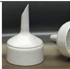
**Funil de Büchner:** Usado em filtração a vácuo e deve ser acoplado a um frasco de kitassato por meio de uma borracha de vedação.
