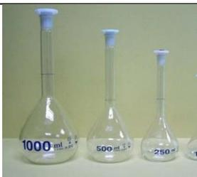
**Balão volumétrico:** Utilizado no preparo e diluição de soluções com volumes precisos. O menisco indica o volume final a ser medido.
