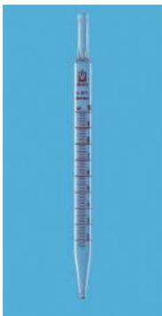
**Pipeta graduada:** É um tubo aberto nas duas extremidades e com uma escala graduada usada para a medição e transferência de (alíquotas) volumes variáveis de líquidos.
